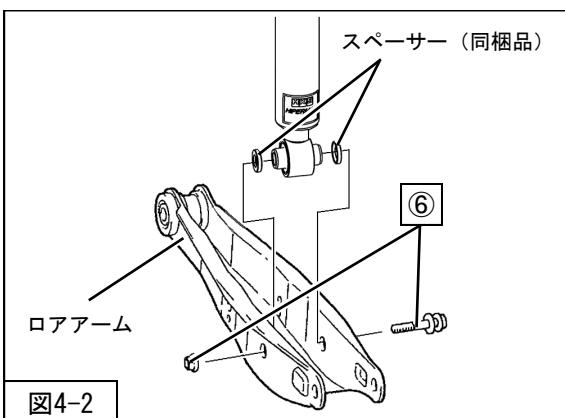
取付けの際、スペーサー（同梱品）を組付けて車両に取付けてください。
