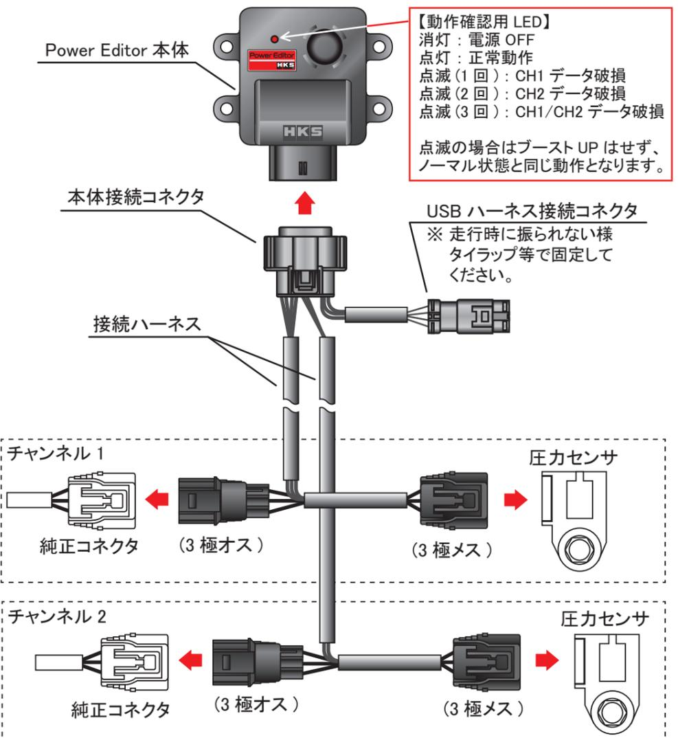
4. 圧力センサからセンサハーネスの純正コネクタを外し、Power Editor の接続ハーネスを割込ませる様に接続する。
