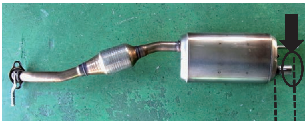
図2. 純正マフラー切断位置
