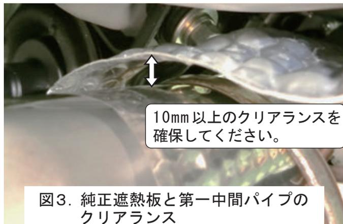
図3. 純正遮熱板と第一中間パイプのクリアランス
