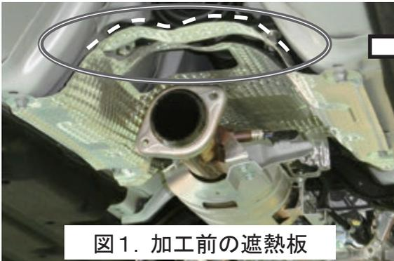
図1. 加工前の遮熱板
