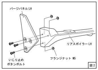
(3) リアスポイラー LHを(1)で取外したクリップ位置に取付けてください。(図3)
