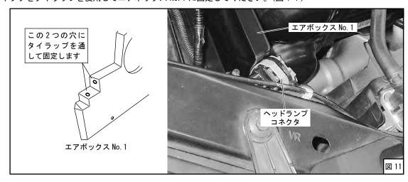
(11) レーシングサクションのサクションパイプをエアボックス No.1 の穴から通し、レーシングサクションを元のように取付けてください。(図 1 2)
