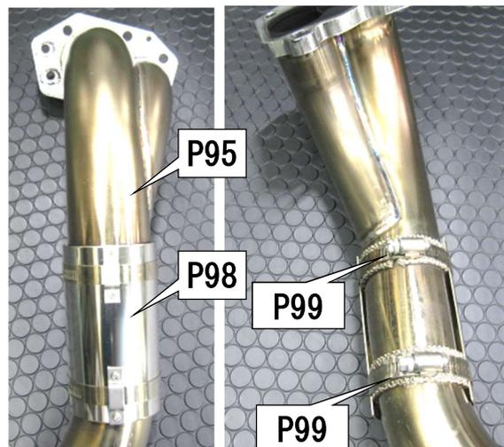
(4) タービンにガスケットを介して(3)で組立てたエクステンションパイプを取付け、ロックナットで仮付けする。
