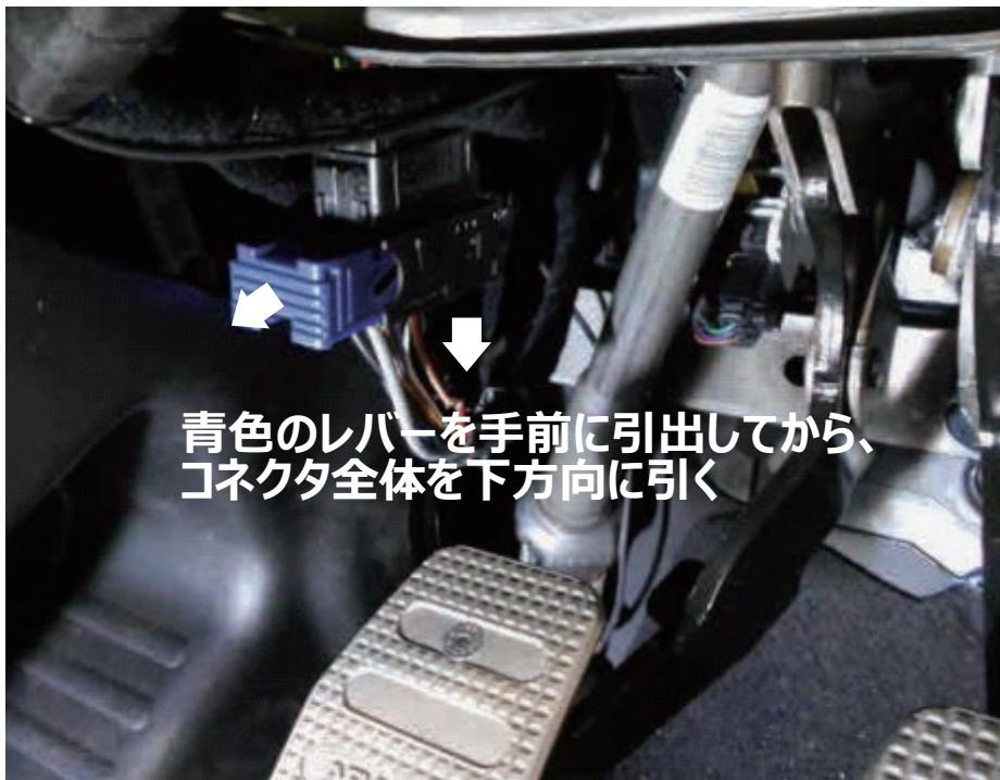
③ 配線図2より対象の電線位置を確認し、2. スプライスの取付け方法に従い、茶色のIG電源線を対象の電線に取付けます。
