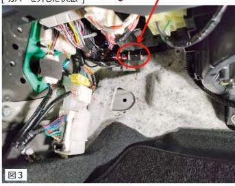
3. 図3の赤丸部分のビニールテープを剥がし、コネクタ(A)(B)を 露出させる。
