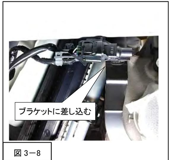
(11) ワイパーリレーの固定ボルトを緩め、ワイパーリレーが下方に移動するようにブラケット上方の穴を使用して再度固定する。
