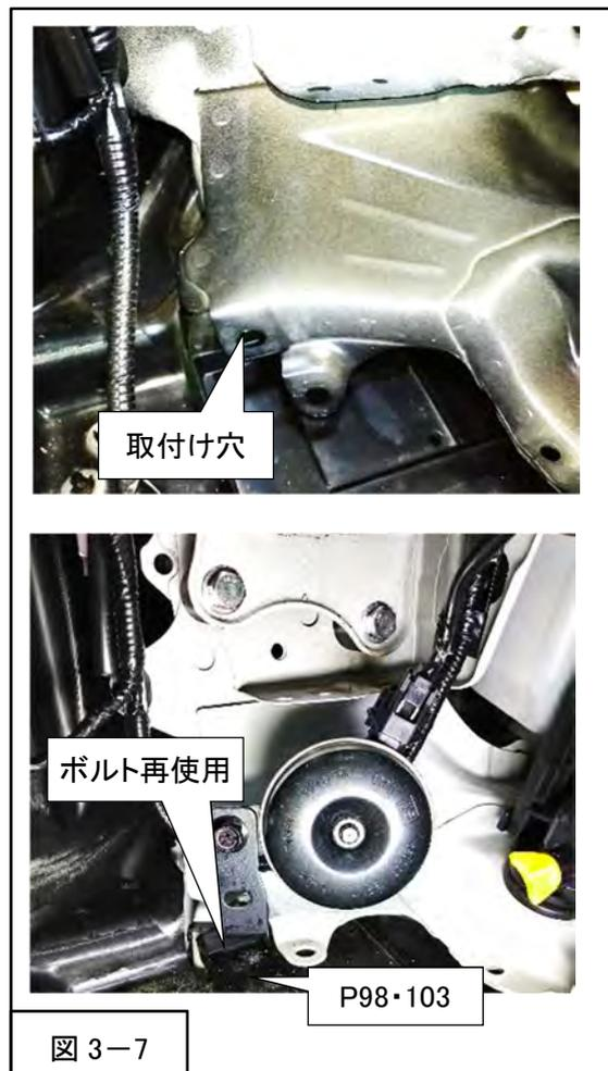
(10) 1.(12)で取外した⑪外気温度センサーをインタークーラーブラケット No.2 に取付ける。
