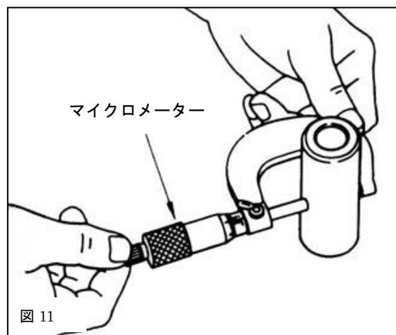
6.3 ピストンピン外径とコンロッド小端部内径からコンロッド小端部オイルクリアランスを算出します。
