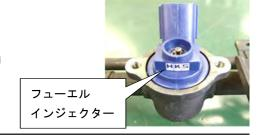
(3) インジェクターに 2. (4) で取外したインシュレータを取付ける。その時、インシュレータは金属板をインジェクター側に向ける。
