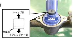
(4)インシュレータ取付け後、フューエルインジェクターキャップを取付ける。
