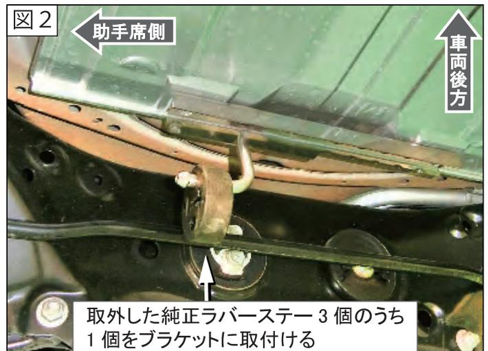
(2) 図1○印(3ヶ所)の純正ラバーステーを外し、1個を(1)で取付けたブラケットに移設してください。
