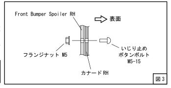
(5) ボディキット TYPE-R の取扱説明書に従い [Front Bumper Spoiler RH] を元のように取付けてください。
