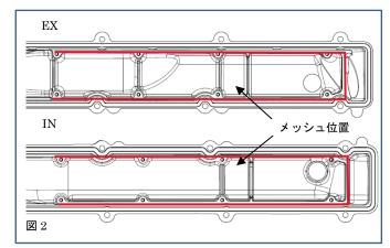
3. 4 カムカバーに本製品を組付け、付属のボルトを使いトルク 0.5kgfm で締付けてください。
