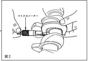
(オイルクリアランス) = (コンロッドメタル内径) - (クランクピン外径)
