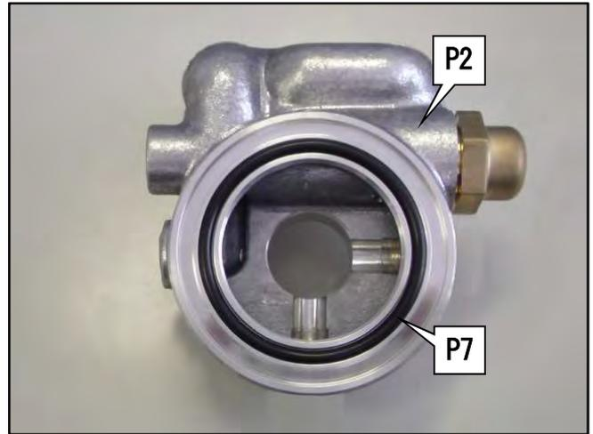
(6) オイルフィルターマウントをスペーサーの上に置き、センターボルトを使用して、エンジンに仮付けしてください。
