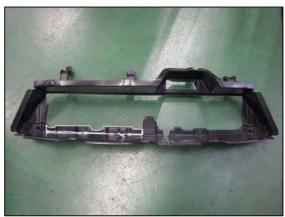
(2)(1)で加工したラジェーターエアガイドを車両に取付けてください。
