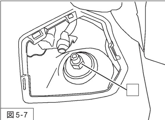
9. ダンパーアップー取付ナットを取外してください。(図5-7)
