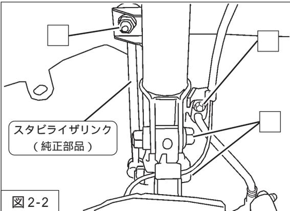
2. ダンパーロア取付ボルト・ナット (締付トルク:  $210\text{N}\cdot\text{m}$ )
