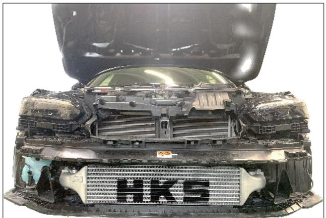
取外した①ボルト×4、②ステー×2、③ボルト×2を使用します。
