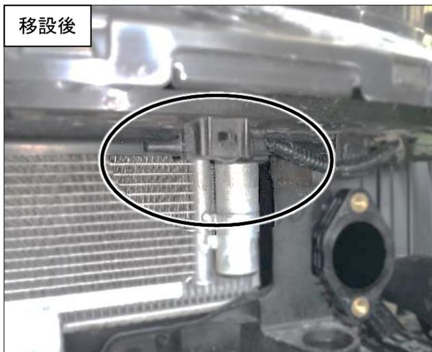
斜線部分を切り取り、図の位置に6mm×6mmの穴をあけ、移設します。
