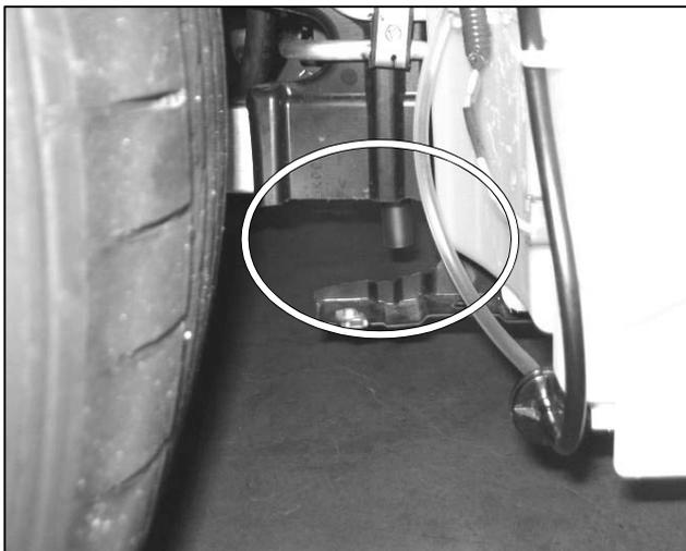
図の○で囲った部分をホースAssy No. 1と干渉しないよう加工してください。
