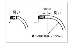
4. 高圧部でホースを直線上に使用する場合、ある程度たるませてください。ホースは加圧によって長さに変化が生じるため、これを補うためにたるみをもたせ、余分な張力がかからないようにしてください。
