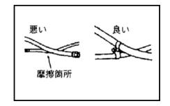
3. ホース部はねじれや過度の曲げによって変形しやすいため、最小曲げ半径(100mm)より小さくならないように配管してください。
