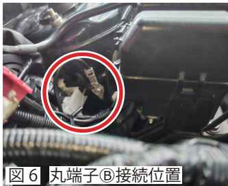
図6 丸端子B接続位置 丸端子B (ヒューズボックスの裏) 締め付けトルク:7.5Nm
