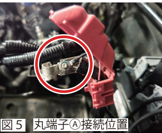
図5 丸端子A接続位置 丸端子A バッテリー端子(+)のナット部
