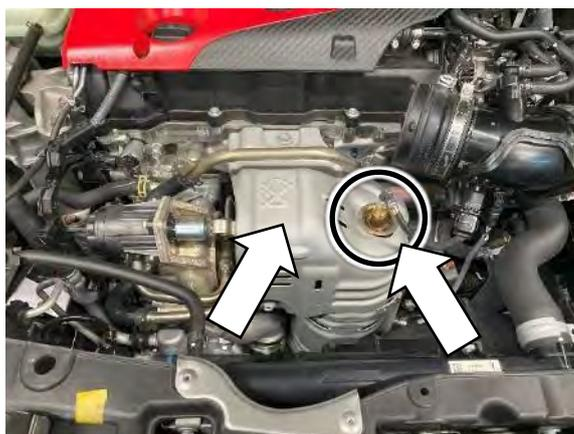
●触媒コンバーターを取り外します。
