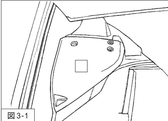
1. リアダンパーASSY上部のカバーを取外してください。(図3-1)
