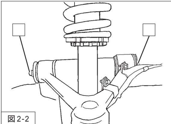
2. アッパーアーム取付ボルト・ナット (締付トルク :  $164\text{N}\cdot\text{m}$ )
