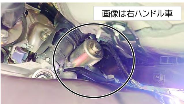
ポンプをトランスファケースとサスメンバーの間を通してサスメンバーの上に配置します。
