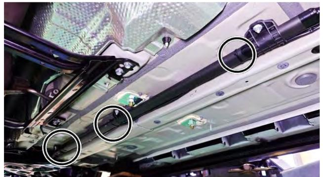
●オイルポンプの電源を接続して固定します。
