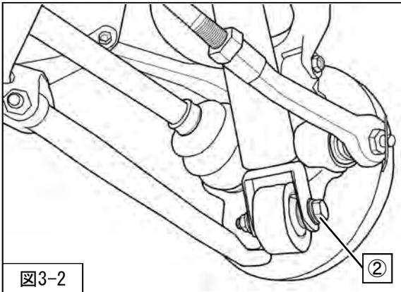
4. ②リアサスペンションASSYロア取付ボルト・ナットを取外してください。(図3-2)
