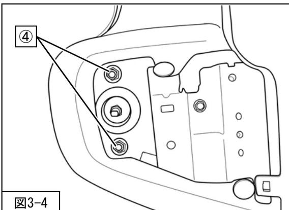
6. ④リアサスペンションASSYアッパー取付ナットを取外してください。(図3-4)
