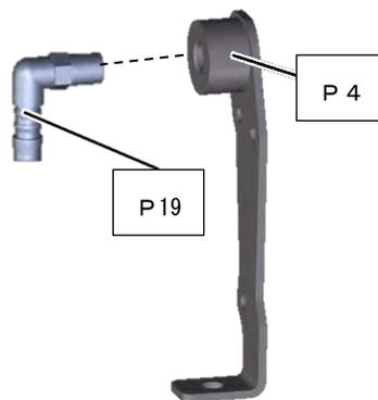
ホースニップルを手で締めこんだ後、スパナ等を用いてさらに1～2回転締め込みます。(座面が接地するまで締めこむ必要はありません)締めこみ過ぎるとサクシジョンパイプが破損します。
