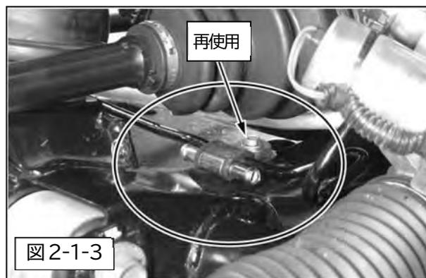
(3) パワーステアリングユニオンにOリングを取付け、車体に取り付けます。(図 2-1-4、2-1-5)
