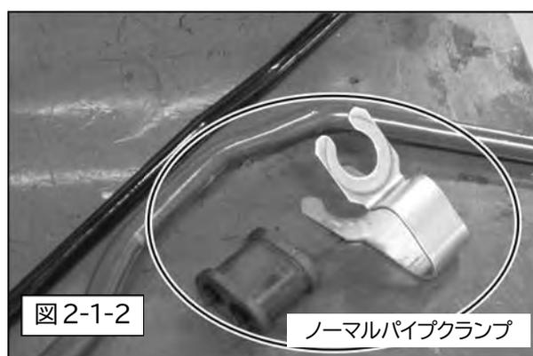
(2) ジョイントパイプを再使用のノーマルパイプクランプに取り付け、車体に取り付けます。(図 2-1-2、2-1-3)
