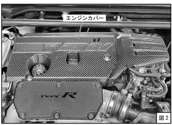
(3) 貼付け箇所を脱脂してエンブレムをエンジンカバーに貼付けてください。(図3)
