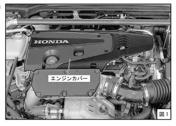
(2) ボルト M6-35 を使用してエンジンカバーを取付けてください。(図2) (締付けトルク: 14N·m {1.43kgf·m})
