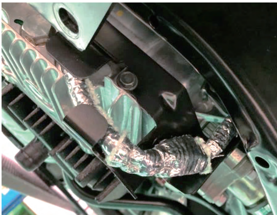
図 2. 遮熱処理後のデファレンシャルギア油温センサハーネス
