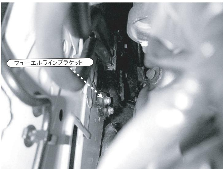
(8)付属の遮熱板A(大)を、運転席側にあるフューエルラインブラケットに純正ボルトを再使用して取付けてください。【図10】
