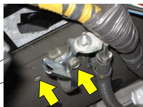
オルタネーターアースのブラケットを取外し、ブラケットが止めてあったネジ穴とその左側のネジ穴へブラケットを固定する。
