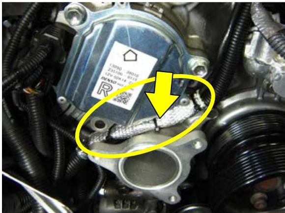
VTCユニットの下を取り回すハーネスは、VTCユニットと後で取付けるウォーターインレットアダプターとの間に挟み込むため、ハーネスをフラットケーブル状に並べてサーモシールで保護する。
