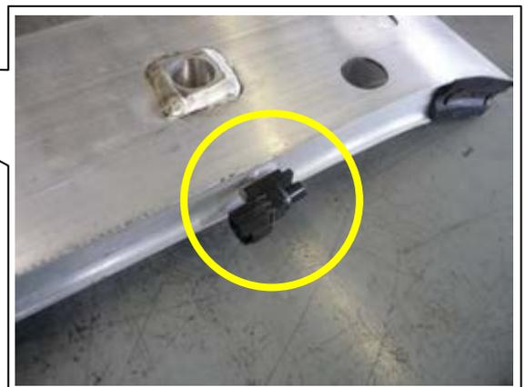
○レインフォース底面、厚さ方向の中心線上にブラインドナットを取付ける。
