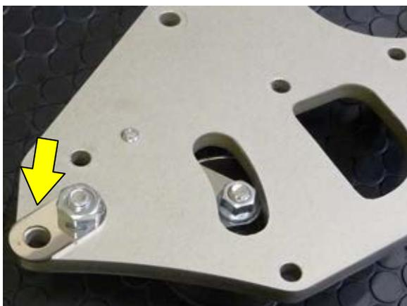
ナット M10 はナットプレート M10 と共締めする。
