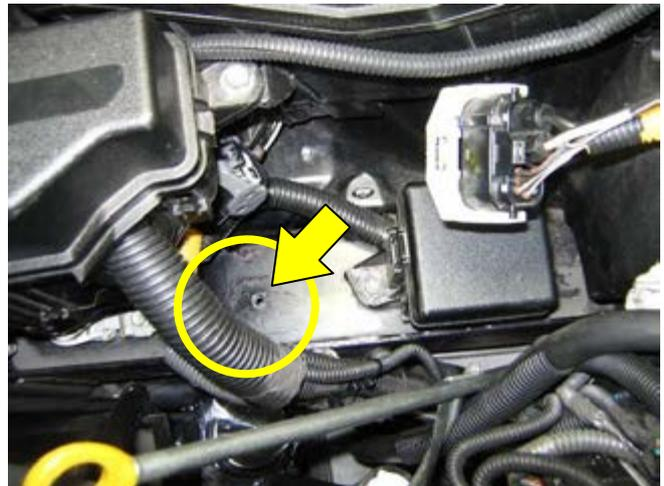
図示したネジ穴にブラケットを取付ける。
